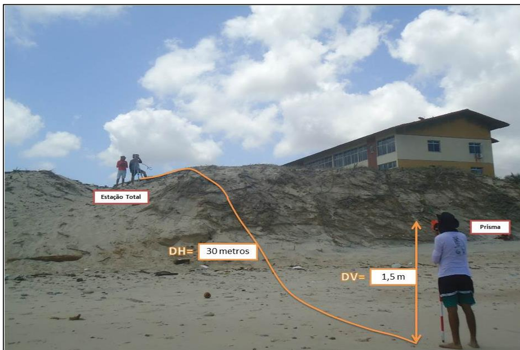
Figura 3 – Esquema de levantamento das cotas topográficas com Estação Total e o Prisma.
